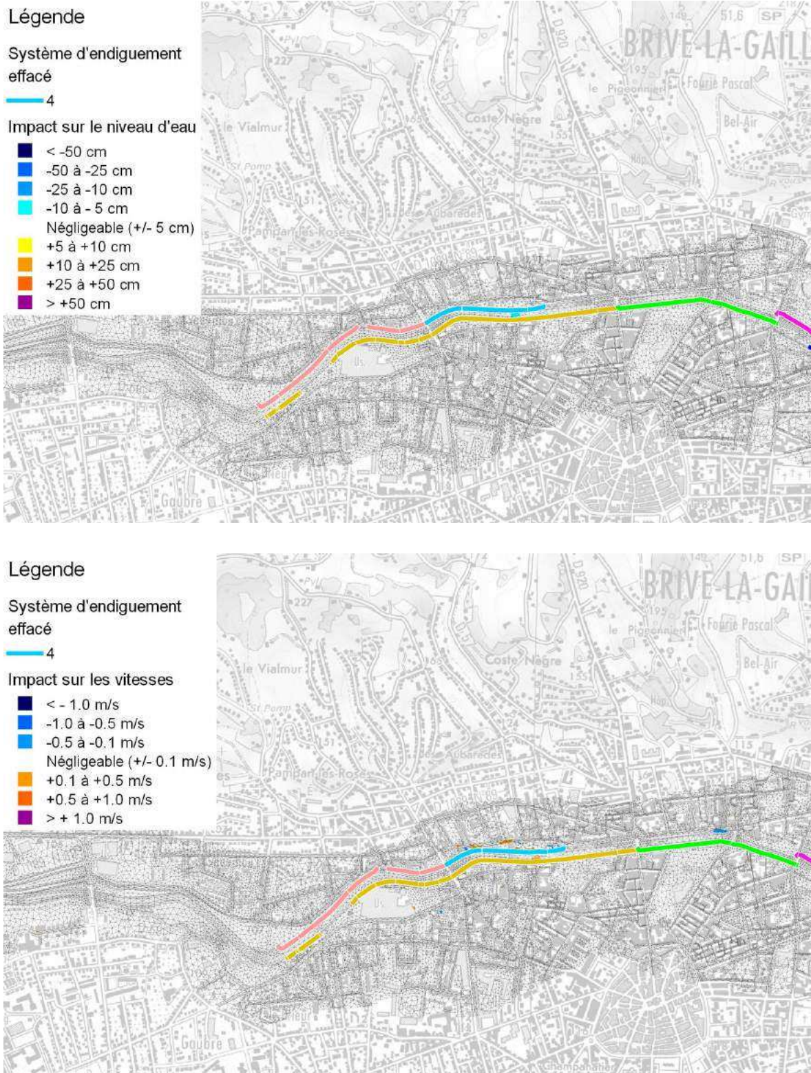
Fig. 21. Impacts sur le niveau d'eau et sur les vitesses de l'effacement du système d'endiguement n°4
